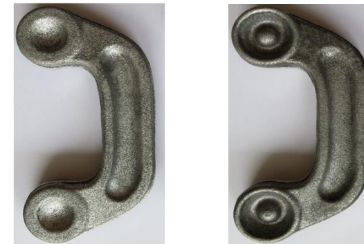
Rys. 4. Ukształtowana odkuwka łącznika ze stopu ZK60 wg nowej technologii w widoku z: (a) góry (b) dołu
