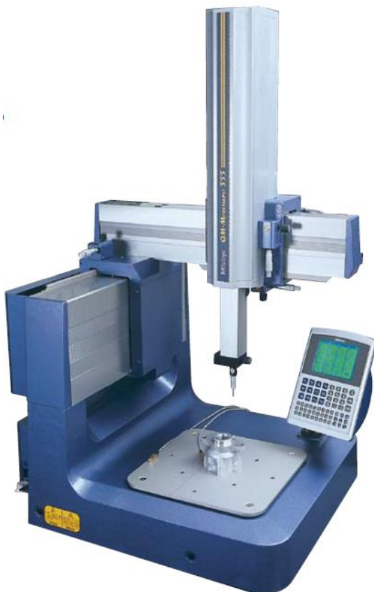
Rysunek 3. Kolumnowa maszyna pomiarowa QM-Measure firmy Mitutoyo, schemat kinematyczny, dane techniczne
