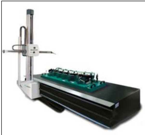
Rysunek 2. Wysięgnikowa maszyna pomiarowa DEA Mercury, schemat kinematyczny, dane techniczne
