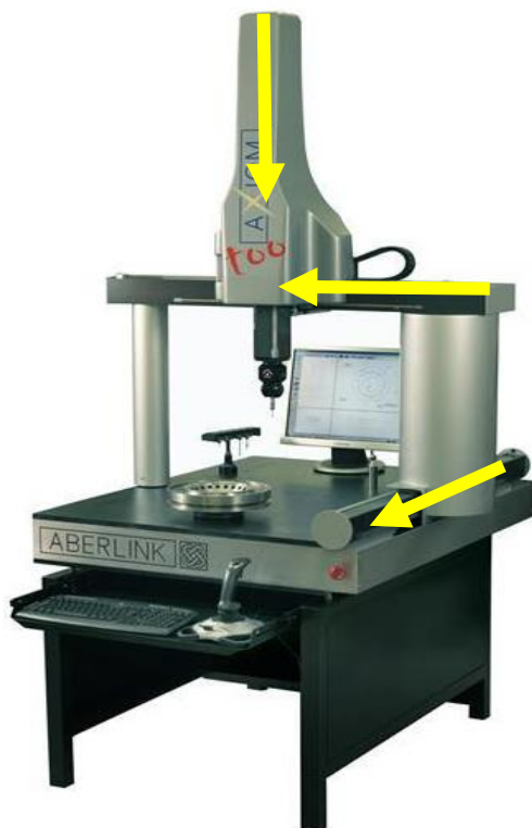
Rysunek 12. Maszyna pomiarowa AXIOM TOO z zaznaczonymi kierunkami osi
